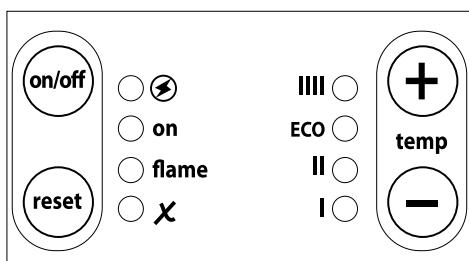
Presione el botón “**on/off**”, el indicador verde “ se ilumina. Presionar las teclas “+” e “-” para establecer la temperatura deseada. El dispositivo realiza una inicialización que dura aproximadamente 6 segundos.
